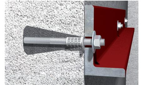
Detail: hinterschnittenes Bohrloch
