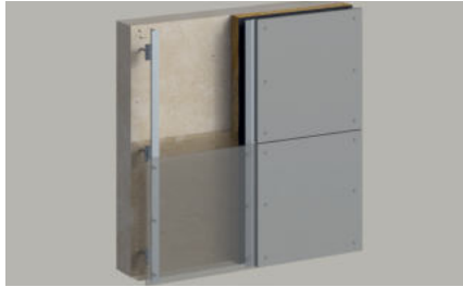
Vorgehängte, hinterlüftete Fassade
