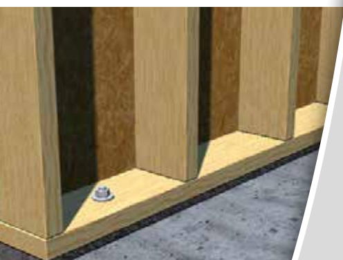
Fixation de lisses basses sur béton
